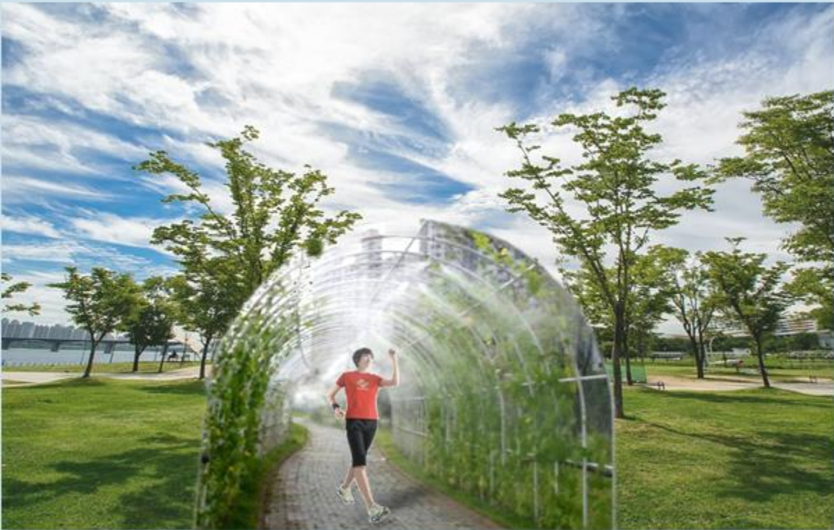
* 쿨링포그 : 미세 물 분자의 기화를 이용해 주위의 온도를 3-5도 낮춰주는 옥외 공간 냉방 시스템
